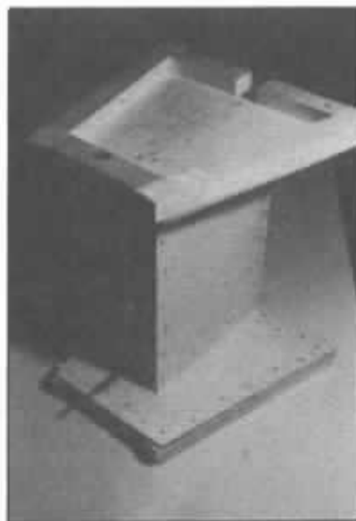
Fig. 9 : Construction de l'enceinte sablée. Les faces supérieures et inférieures sont assemblées sur l'âme centrale.
